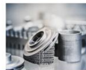
Additive Fertigung • EOS M290 (250x250x325) • 53316L, 17-4PH, AlSi10Mg • Erweiterung aus MS1 im Q3 23 • Kapazität Flexibel Erweiterbar
