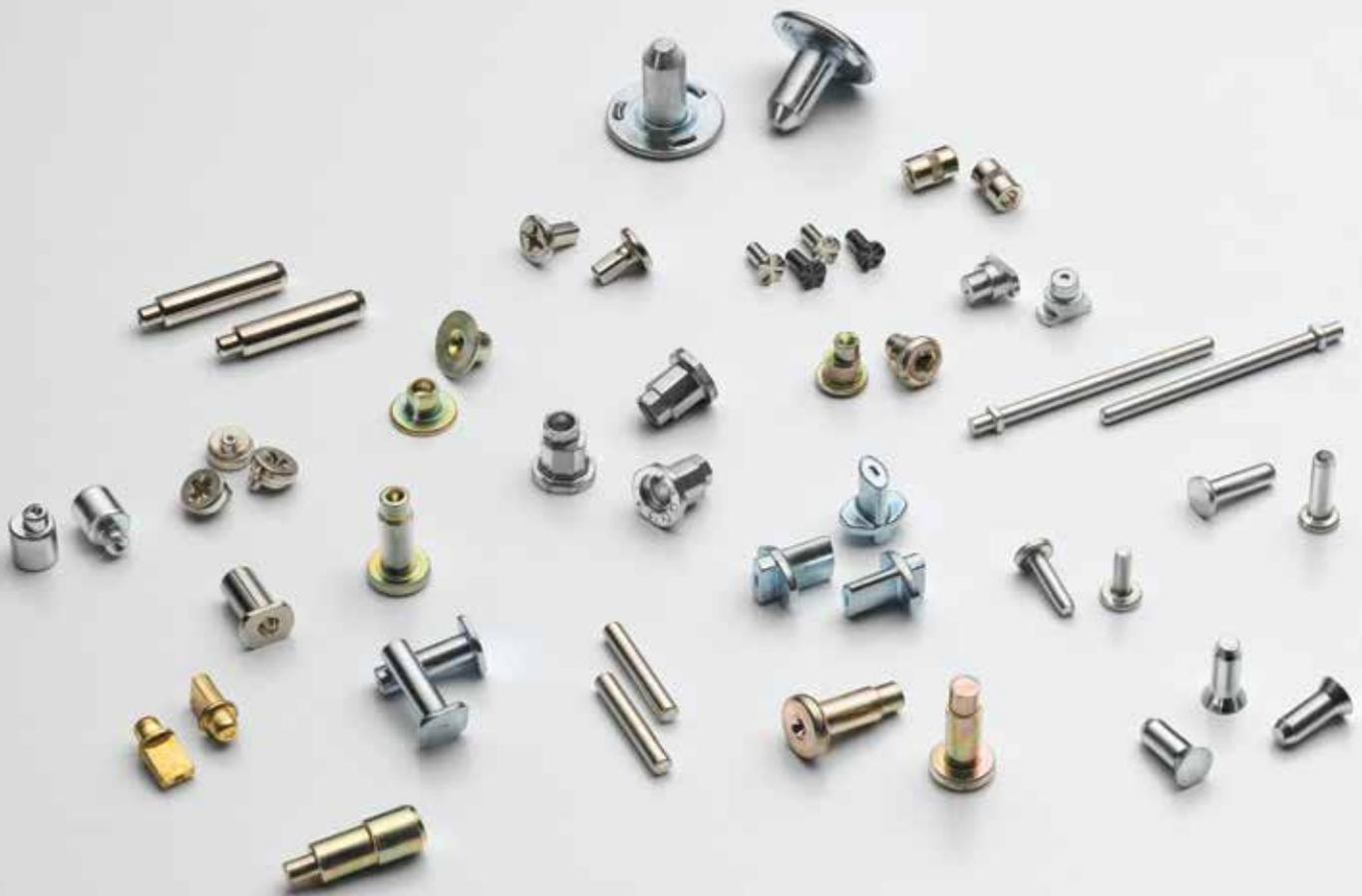
Mit dieser rationellen Fertigungstechnologie produzieren wir aus Drahtabschnitten von 2 bis 12 mm Durchmesser auf modernsten Anlagen von National und Hilgeland in zwei bis sieben Umformstufen hochpräzise Formteile. Vorteile des Verfahrens: optimierter Materialeinsatz, hohe Mengenleistung, spezielle Formgebungsmöglichkeiten, wirtschaftliche Alternative zu Drehteilen, hohe mechanische Belastbarkeit der Teile und maximale Reproduktionsgenauigkeit.
